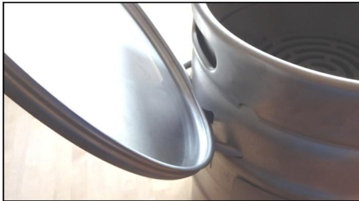
**Abbildung 7:** Einhängen des Deckels
