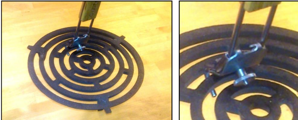
**Abbildung 11:** Anheben des Feuerrostes mit Hilfe des universellen Handgriffs.
