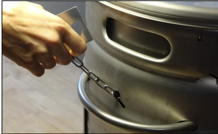
**Abbildung 8:** Höhenverstellung des Brennstoffbehälters
